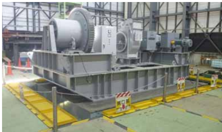
第8図 開閉装置の試験装置（全景）
