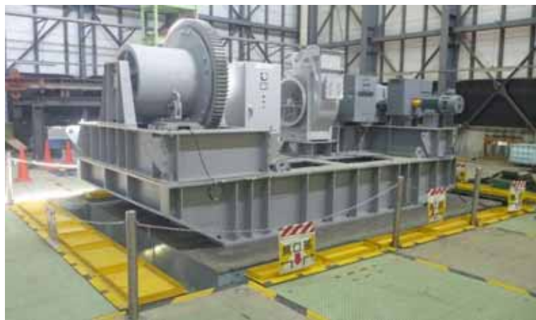
第8図 開閉装置の試験装置（全景）
