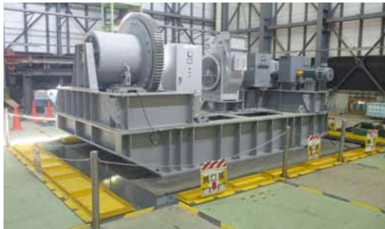
第10図 開閉装置の試験装置（全景）
