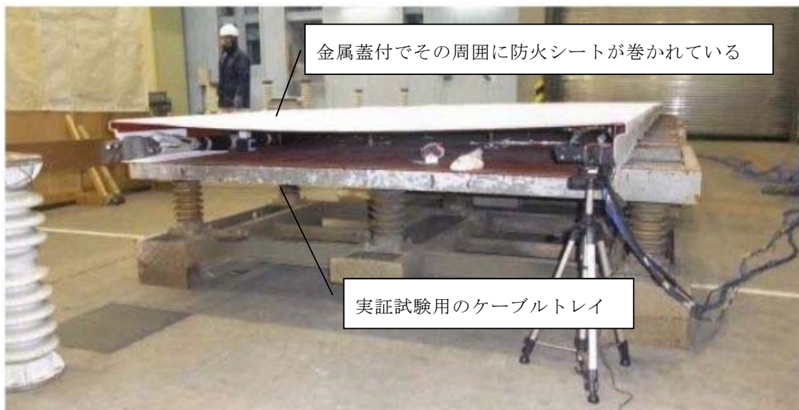
第 3 図 実証試験用のケーブルトレイ
