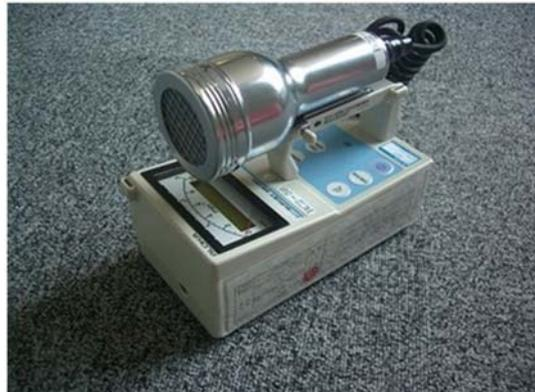
第5.2-2図 GM汚染サーベイメータ
