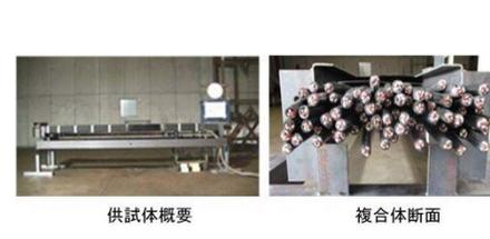
耐延焼性確認試験(水平トレイ)概要
