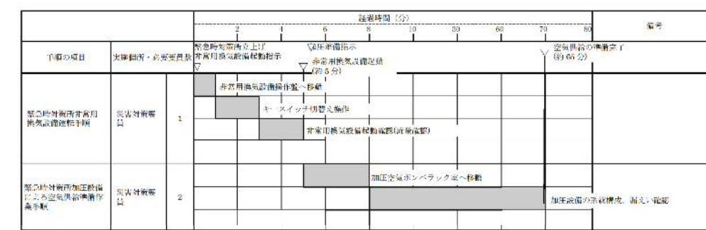
第1.18.2.1-2図 緊急時対策所非常用換気設備運転及び加圧設備による空気供給準備手順のタイムチャート
