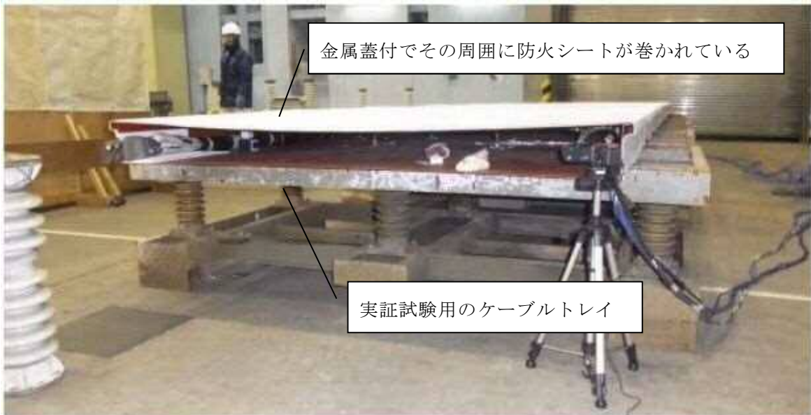
第3図 実証試験用のケーブルトレイ
