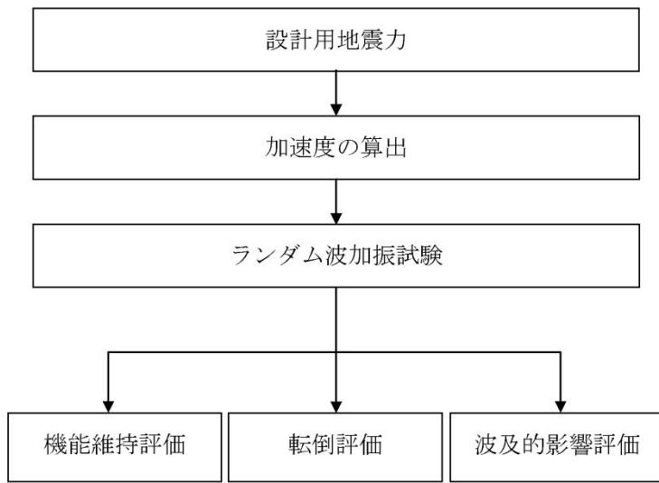
図 2-3-1 耐震評価フロー
