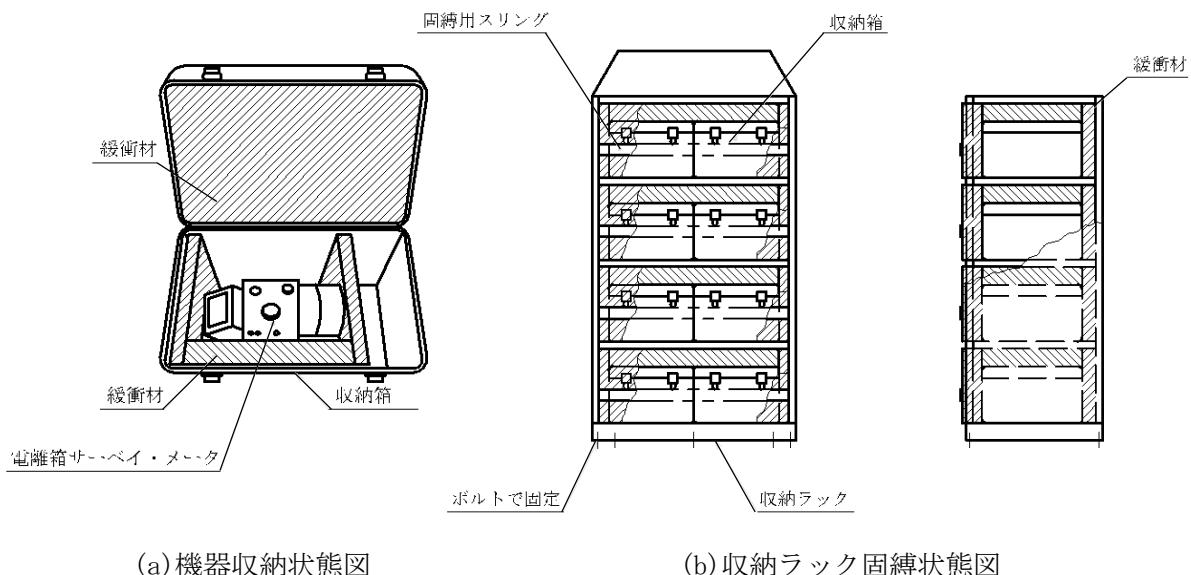
図2-2-1 収納ラック固縛保管概要図
