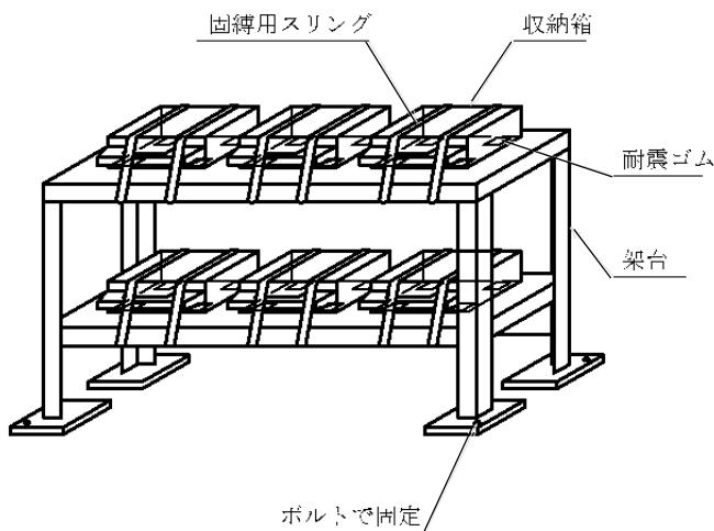
(b) 収納箱架台固縛状態図
