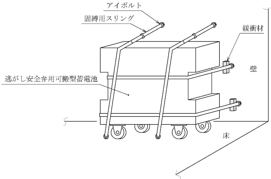
図 2-2-3 本体固縛保管概要図
