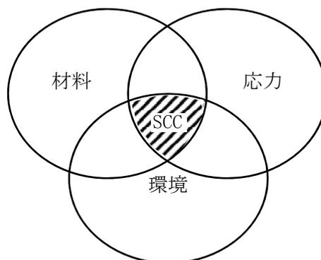
一般的に応力腐食割れを抑制するためには、以下に示すように3 要因のうちの1 要因以上を取り除く必要がある。
