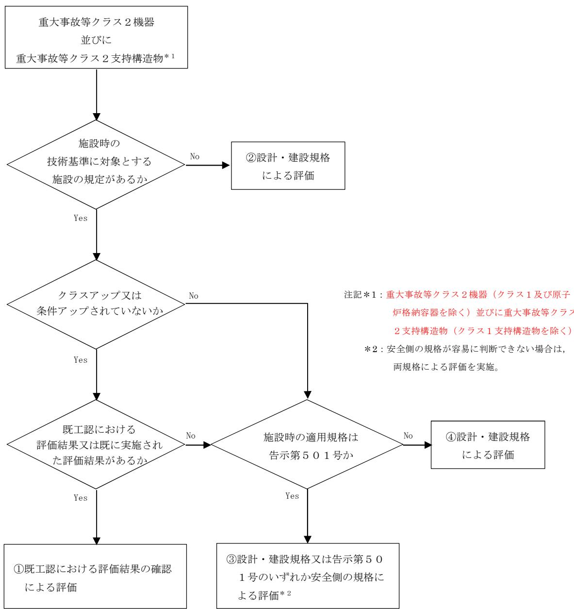
図2-1 評価区分の整理フロー
