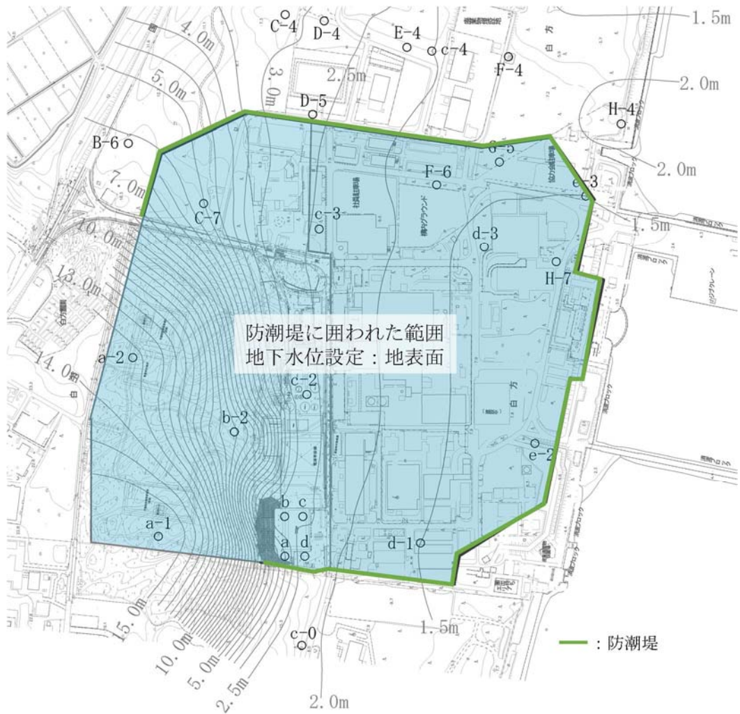
第 10-3 図 地下水位の設定図
