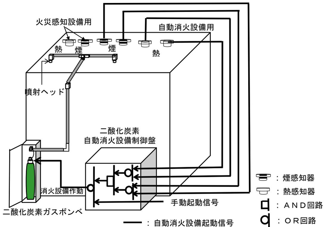
第5-5図 二酸化炭素消火設備の概要
