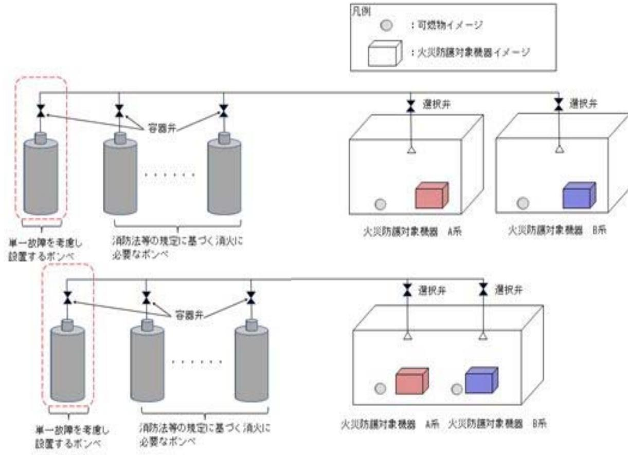
第6-6図 全域ハロン消火設備の系統構成
