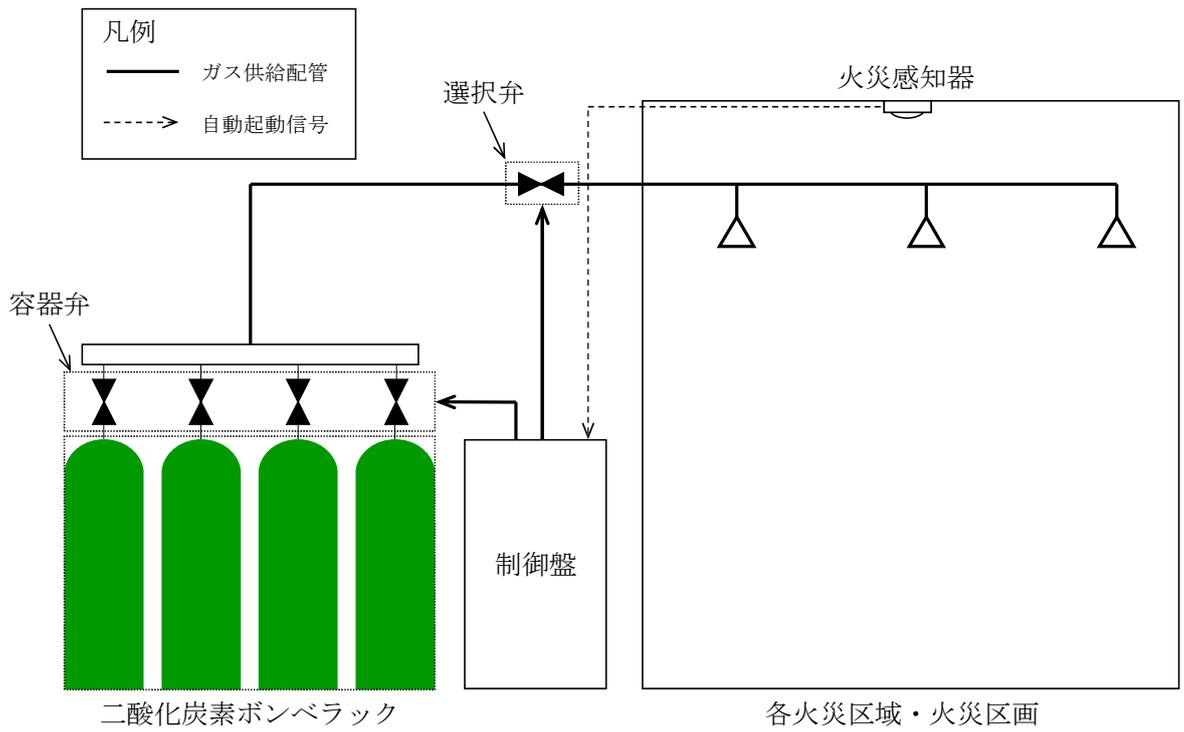
第5-10図 二酸化炭素消火設備 自動起動信号
