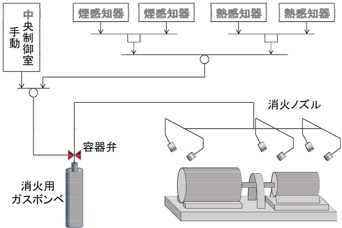
第5-3図 局所ハロン消火設備の概要図
