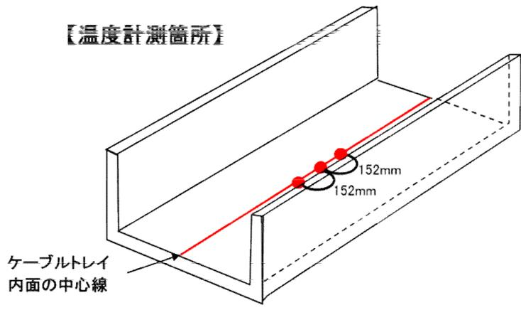
第6-4図 発泡性耐火被覆を施工した鉄板の1時間耐火能力を確認する
