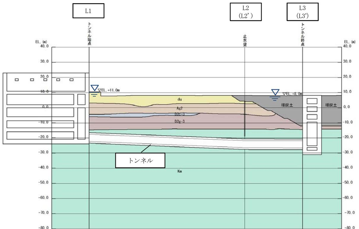
第1.4.5-3 トンネル 耐震評価候補断面位置
