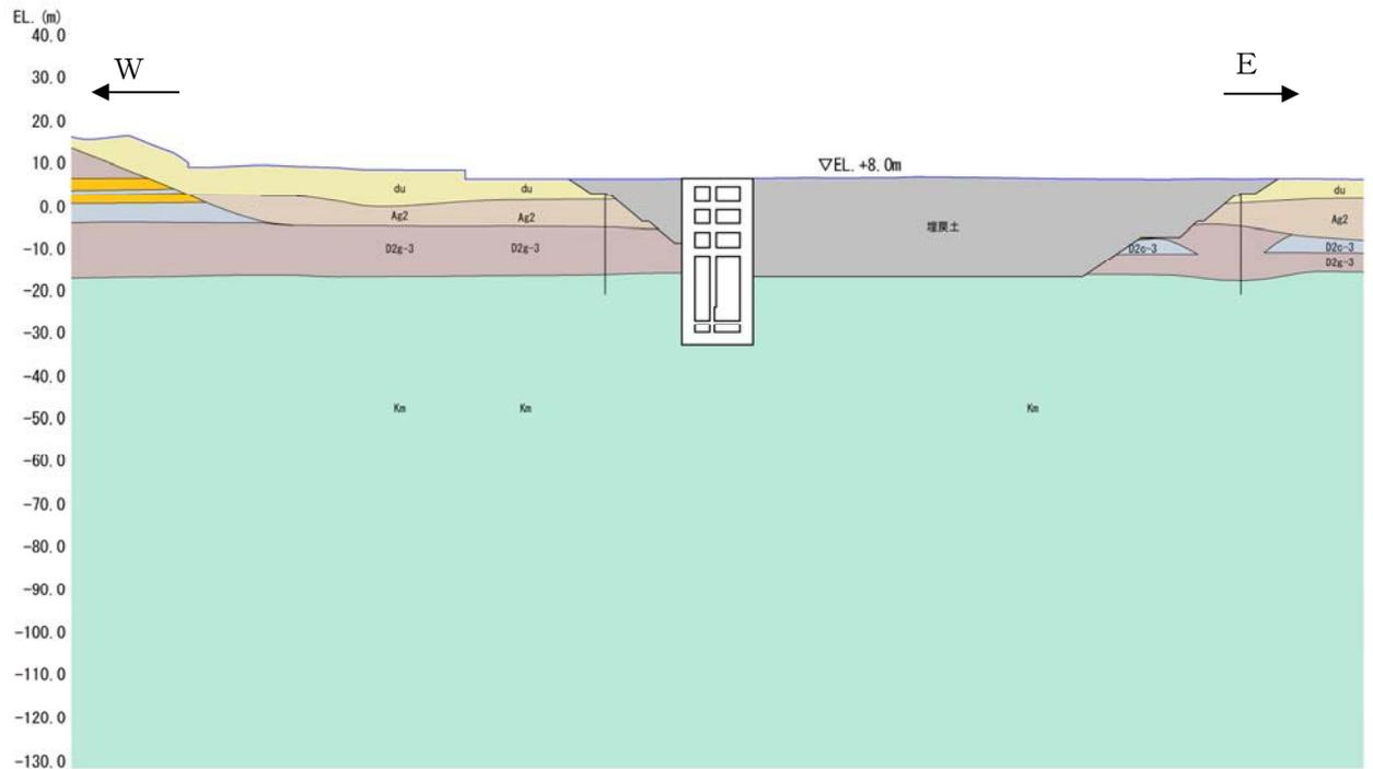
第 1.4.6-5 図 (2) 立坑の評価対象断面 (東西方向断面)
