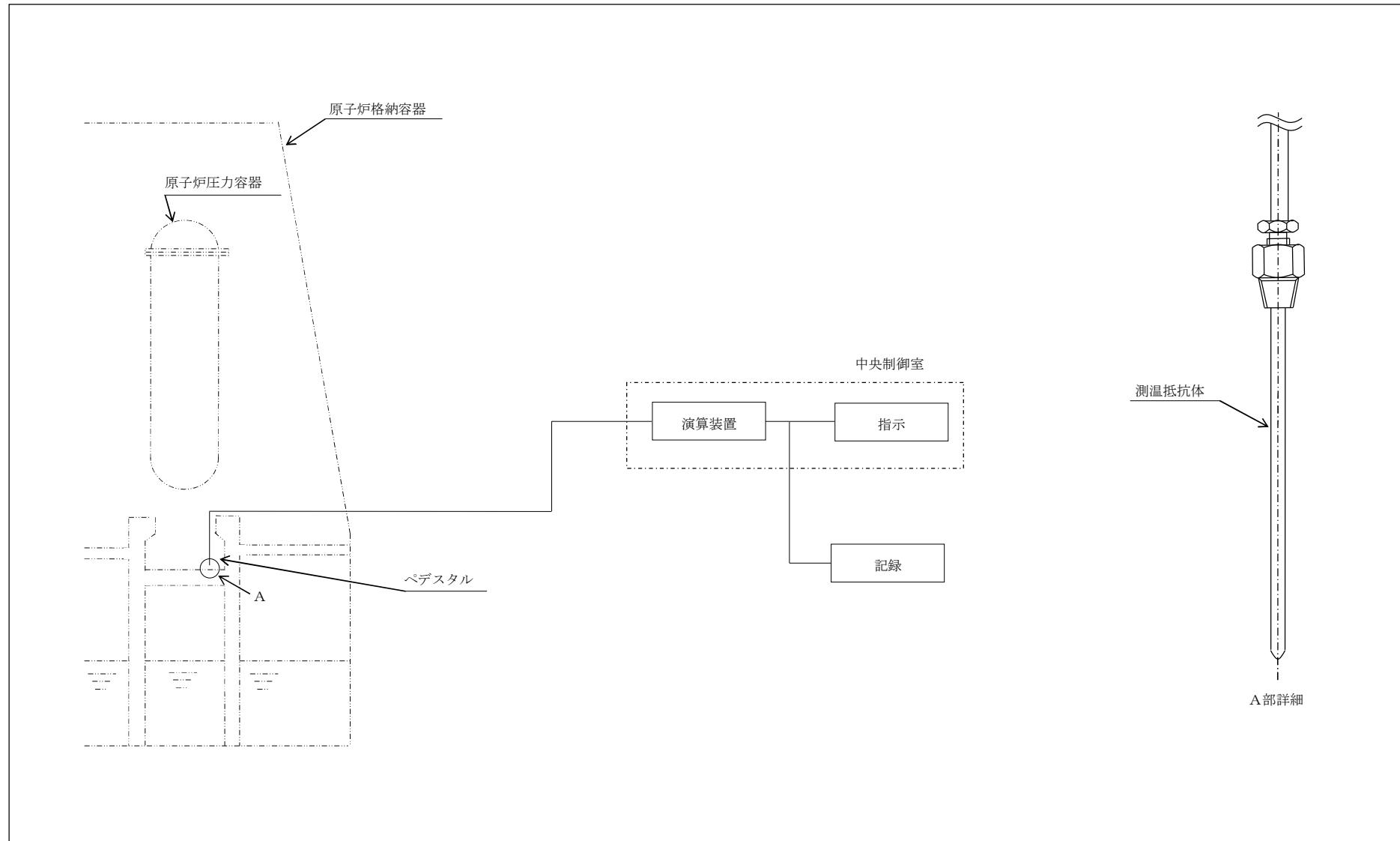
図 3-1-4-16 検出器の構造図（格納容器下部水温）
