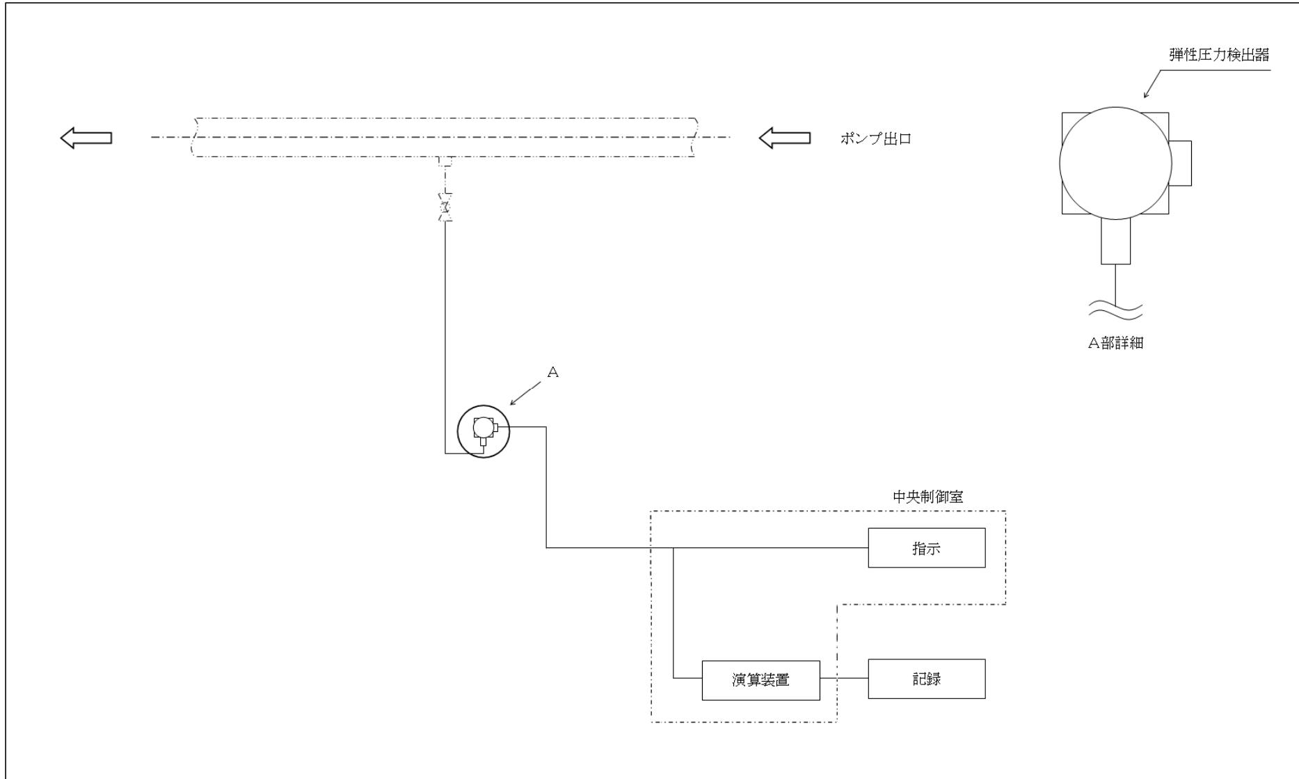
図 3-1-9-16 検出器の構造図（常設高圧代替注水系ポンプ吐出圧压力）
