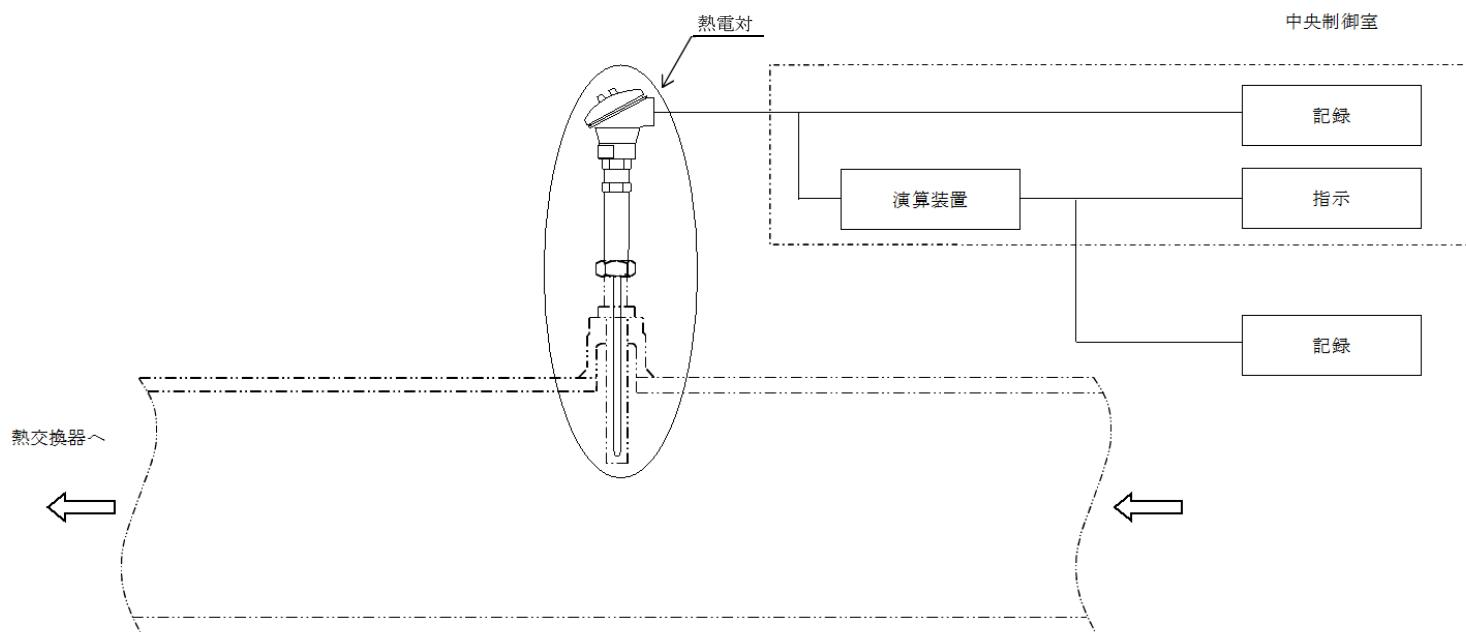
図 3-1-2-12 検出器の構造図 (残留熱除去系熱交換器入口温度)
