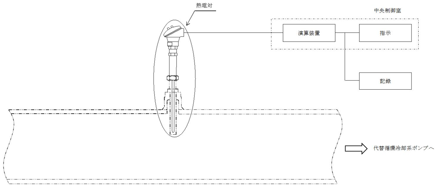
図 3-1-2-10 検出器の構造図（代替循環冷却系ポンプ入口温度）
