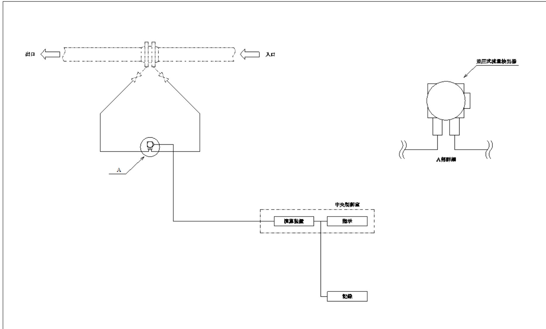
図 3-1-6-2 検出器の構造図 (低圧代替注水系格納容器スプレイ流量)
