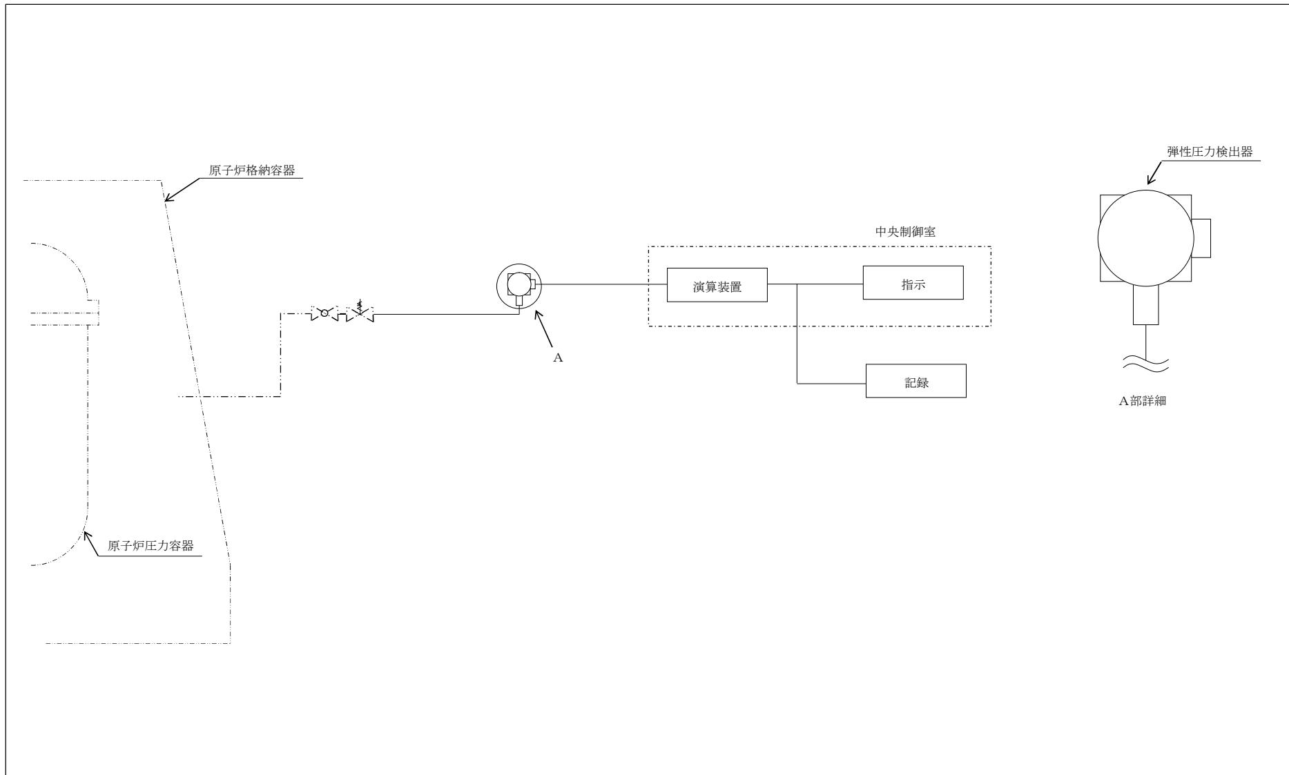
図 3-1-4-2 検出器の構造図 (ドライウェル圧力)
