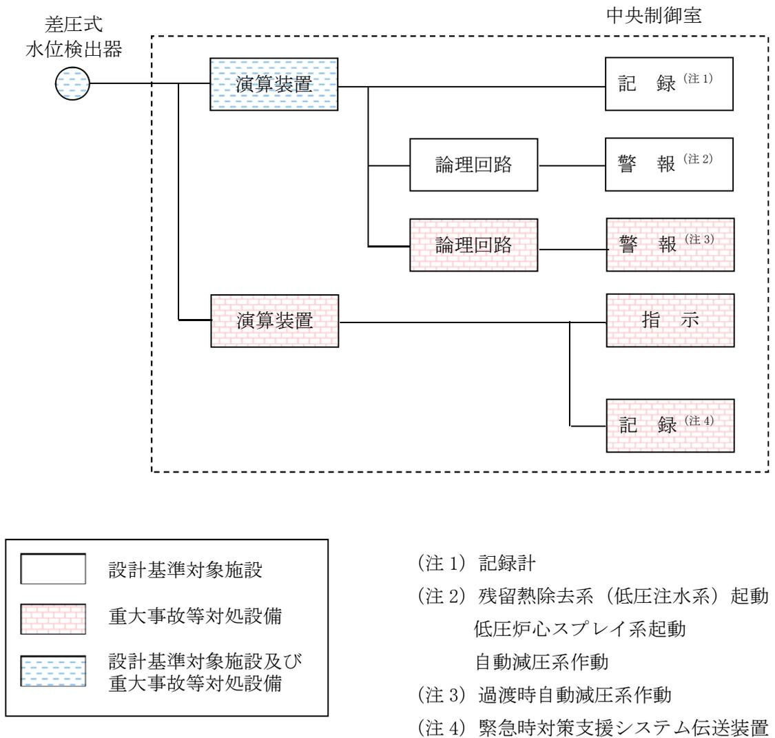
図 3-1-3-5 原子炉水位（広帯域）の概略構成図
