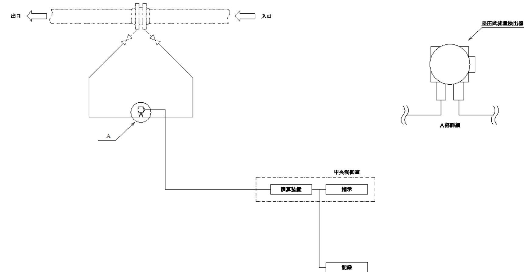
図 3-1-6-2 検出器の構造図（低圧代替注水系格納容器スプレイ流量）
