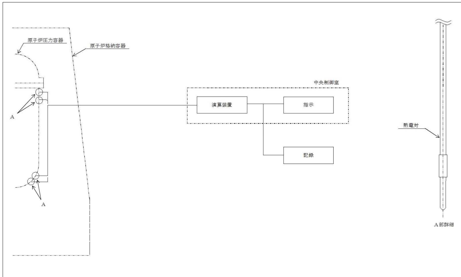
図 3-1-2-2 検出器の構造図（原子炉圧力容器温度）
