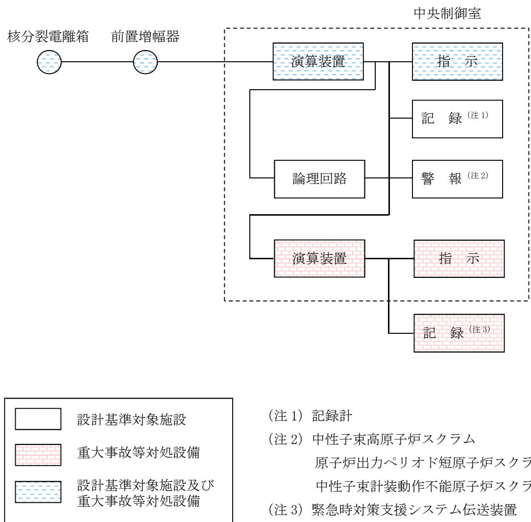
図 3-1-1-1 起動領域計装の概略構成図
