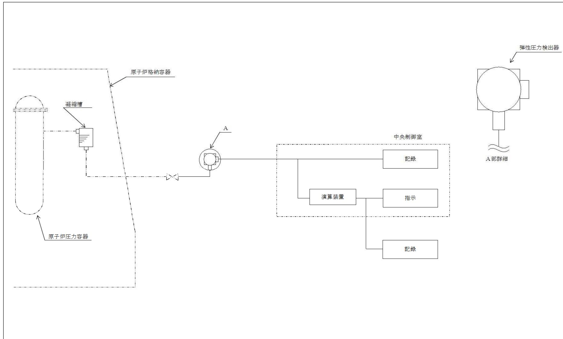
図 3-1-3-2 検出器の構造図（原子炉圧力）
