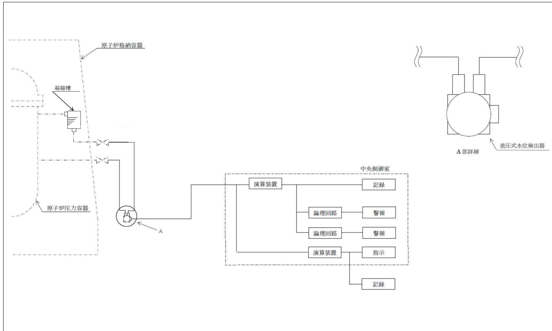
図 3-1-3-6 検出器の構造図（原子炉水位（広帯域））
