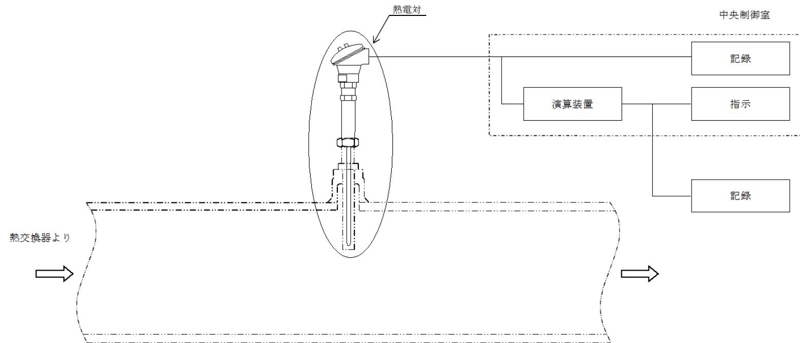
図 3-1-2-14 検出器の構造図（残留熱除去系熱交換器出口温度）
