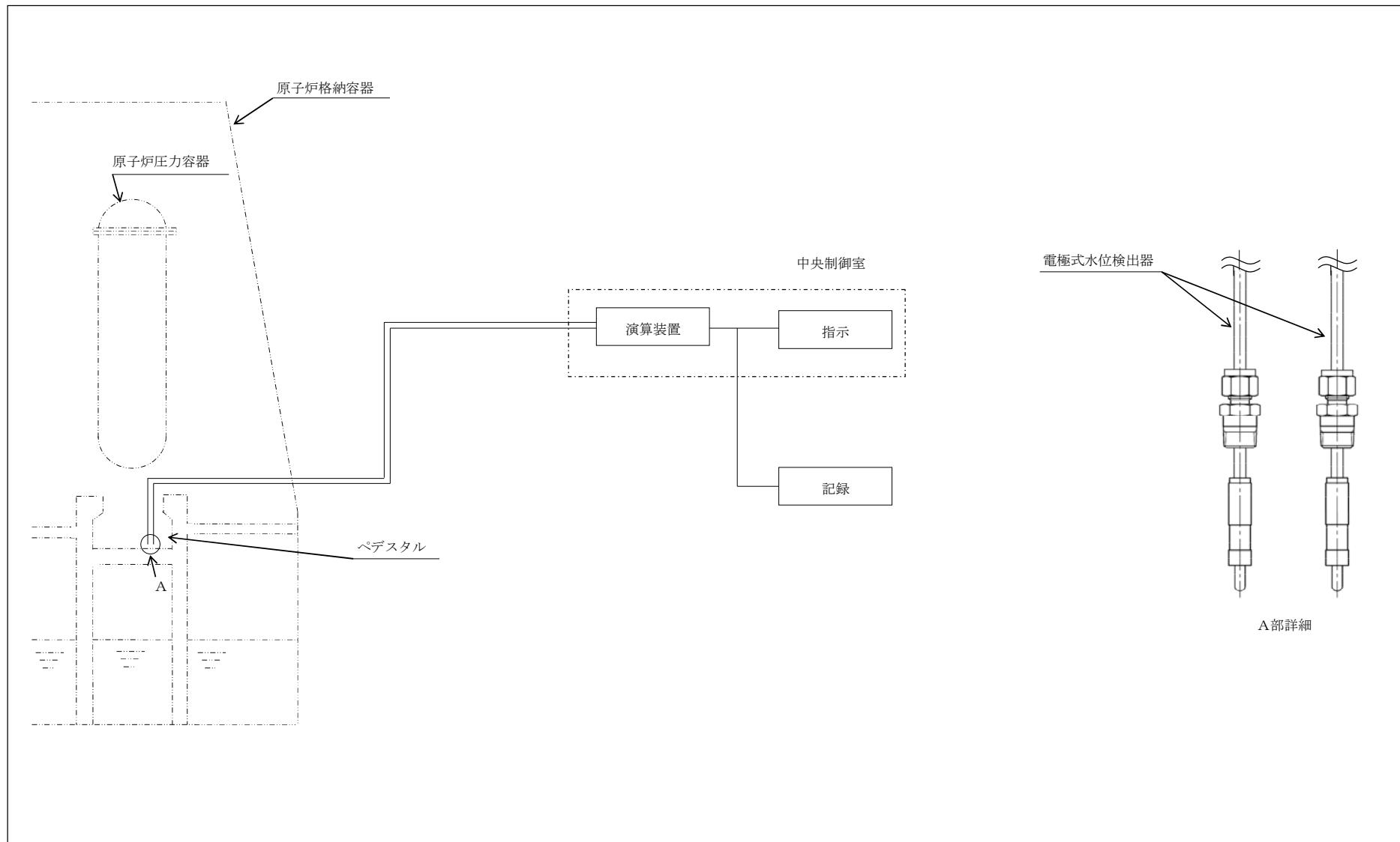
図 3-1-7-4 検出器の構造図（格納容器下部水位）
