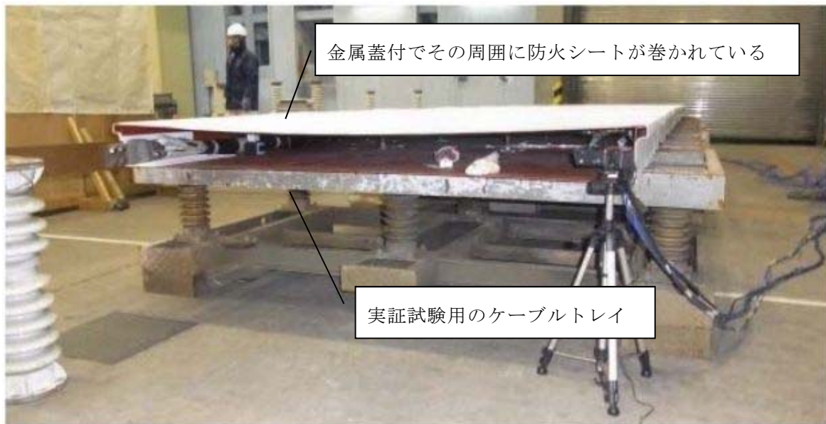
第3図 実証試験用のケーブルトレイ
