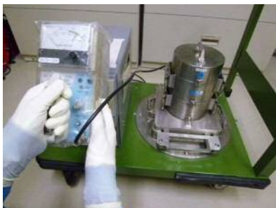
第1図 放射性物質の濃度の測定例
