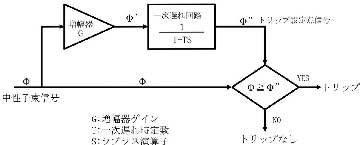
中性子束信号 $\Phi$ を増幅器及び一次遅れ回路を通過した信号 $\Phi''$  (トリップ設定点信号)と比較し $\Phi$ が $\Phi''$  以上の場合にはトリップ信号を発生する。
