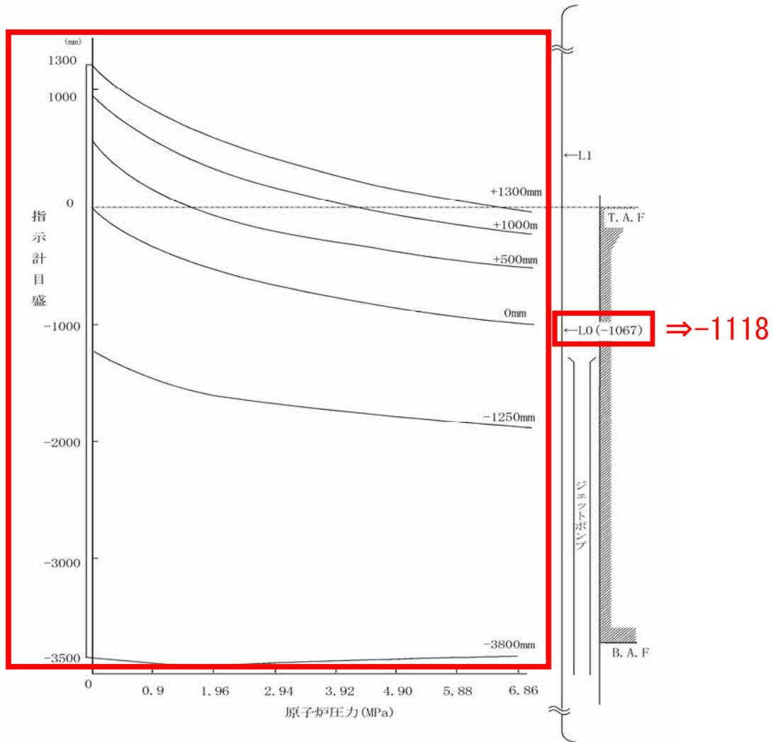
第2図 原子炉水位（燃料域）及び原子炉水位（S A燃料域）補正曲線
