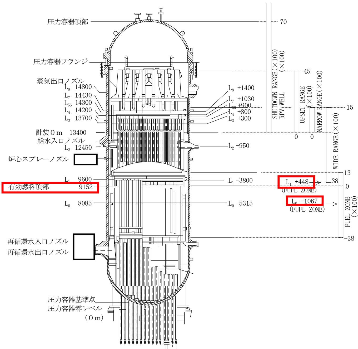
図1 原子炉水位計の指示範囲
