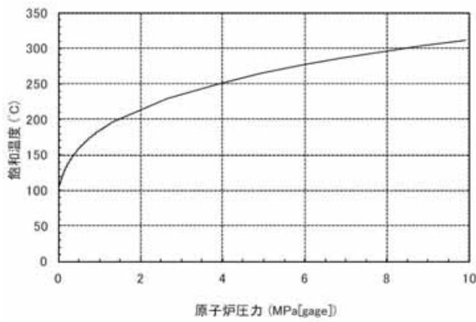
図 58-7-3 飽和温度／圧力の関係を利用した圧力の推定
