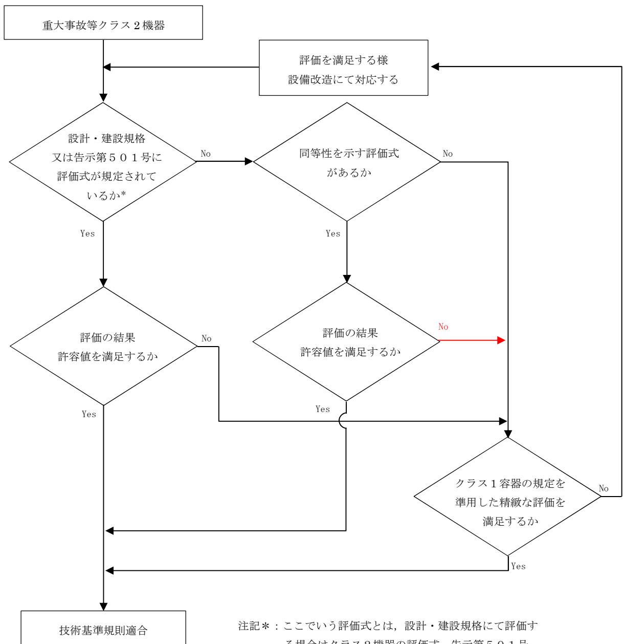
図2-2 重大事故等クラス2機器の技術基準規則適合性確認フロー
