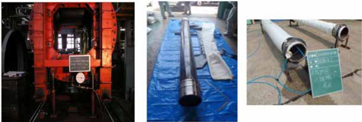
第 13 図 止水ゴム等の耐圧試験例
