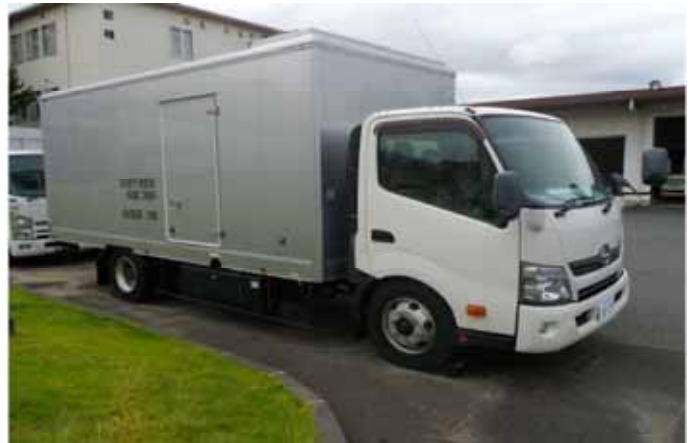
可搬型代替低圧電源車
