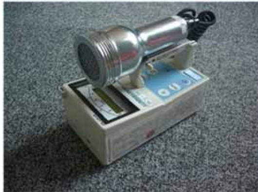
第5.2-2 図 GM汚染サーベイメータ
