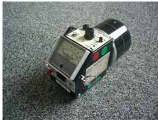
第5.2-3図 電離箱サーベイメータ
