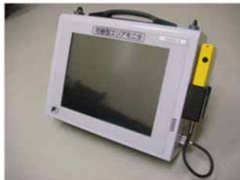
第5.2-1図 可搬型エリアモニタ
