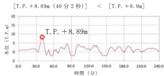
S A用海水ピットにおける上昇側の入力津波の時刻歴波形
