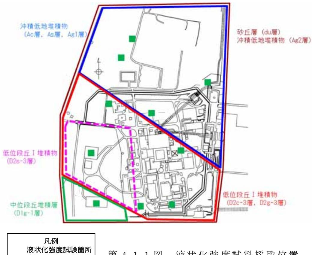
第 4.1.1 図 液状化強度試験試料採取位置
