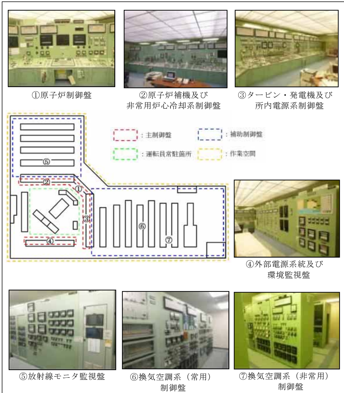
第 2.4.1-1 図 中央制御室の制御盤配置
