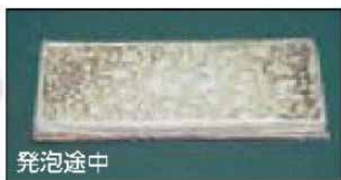
200℃～250℃程度で発泡を開始し、断熱層を形成
