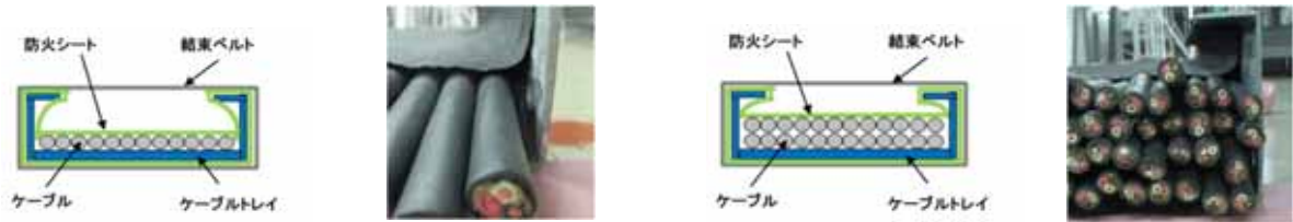
a. ケーブル少量時の施工断面
