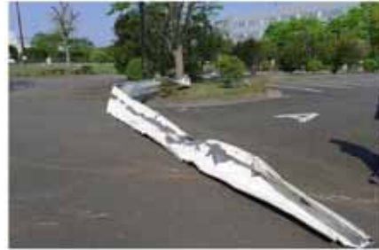
飛散した飛来物（鋼板製屋根材）
