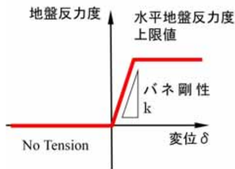
第 3-72 図 水平方向バネ特性（杭及び壁バネ）
