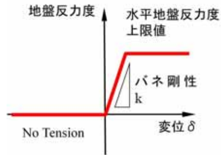
第 1-14 図 F E M 解析に与える地盤バネの特性
