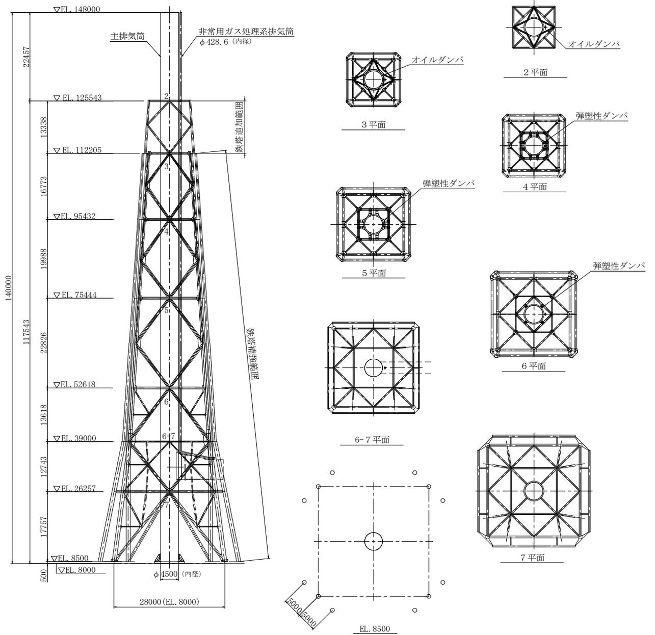
図 2-2 主排気筒及び非常用ガス処理系排気筒の構造概要図 (単位 : mm)
