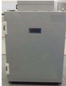
図 2-5 可搬型モニタリング・ポスト
