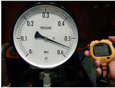
第 5.14.1.2-31 図 試験 No. ⑥ 加圧状況 (0.55MPa)
