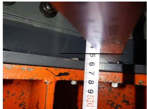
枠間距離計測状況 枠間距離：初期値 612 mm + 伸び 138 mm = 750 mm
