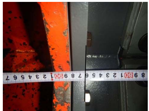
第 5.14.1.2-13 図 試験 No. ④ 枠間距離計測（底版：北側）
