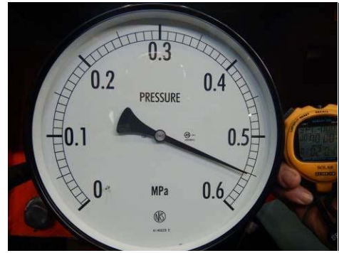
第 5.14.1.2-17 図 試験 No. ④ 全体状況 (0.55 MPa, 1 時間保持後)
