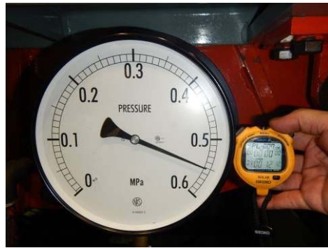
第 5.14.1.2-32 図 試験 No. ⑥ 加圧完了 (0.55MPa, 1 時間保持)
