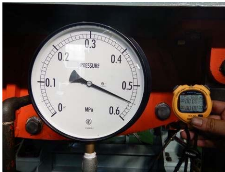
第 5.14.1.2-23 図 試験 No. ⑤ 加圧状況 (0.55 MPa)
