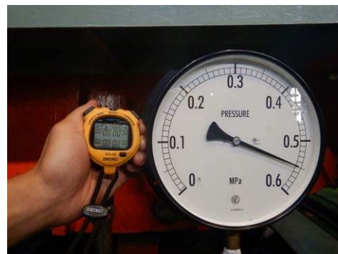
第 5.14.1.2-15 図 試験 No. ④ 加圧状況 (0.55 MPa 加圧開始)
