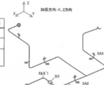
参表 4.4-7(1) 実規模配管系試験 (計測位置: エルボ 2)
