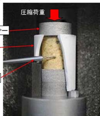
試験片設置状況(1800°C、2000°C)
