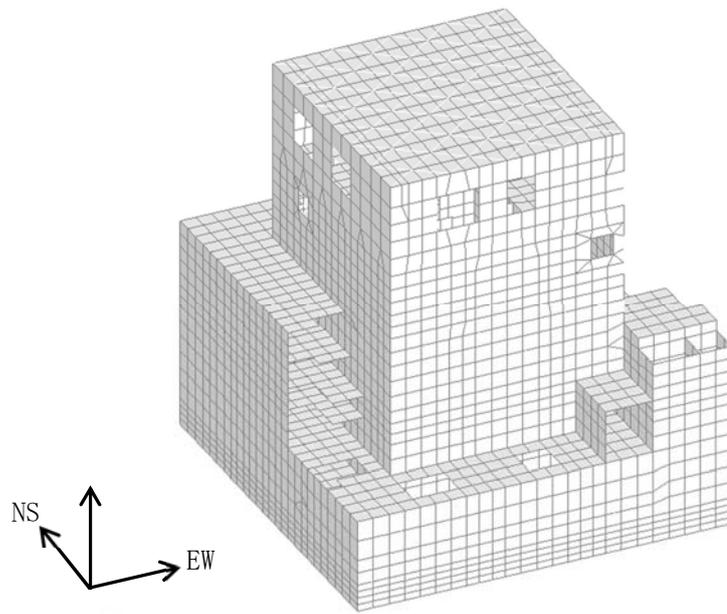
図 3-1-4 原子炉建屋の 3 次元モデルの概要図
