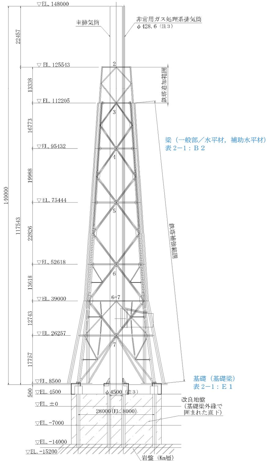
図 2-13 主排気筒の概略側面図
