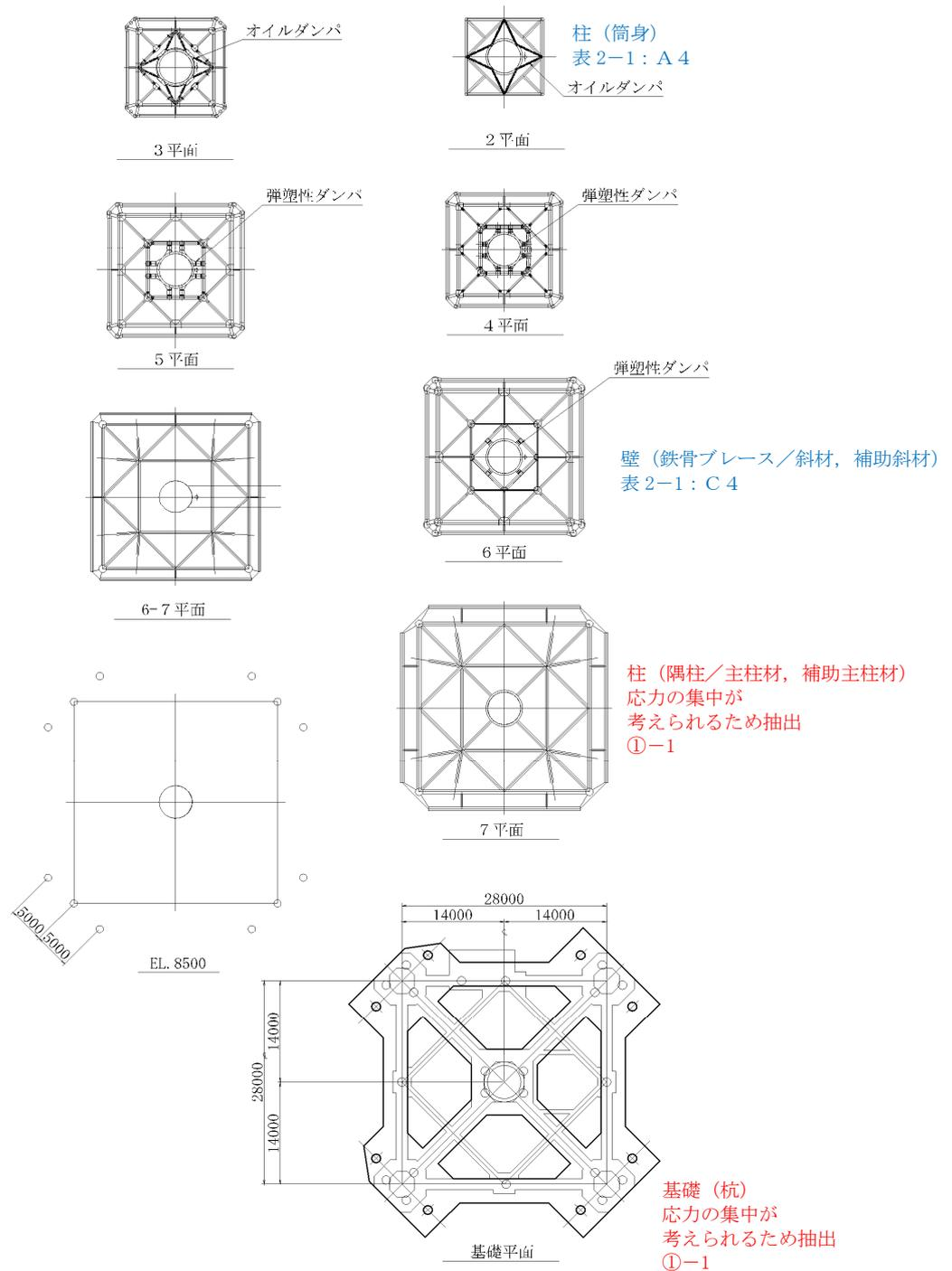
図 2-12 主排気筒の概略平面図
