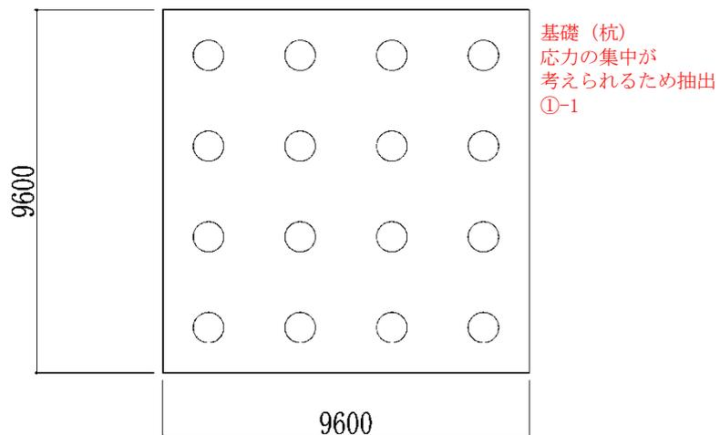
図 2-14 非常用ガス処理系配管支持架構の杭伏図 (EL. 5.2 m)
