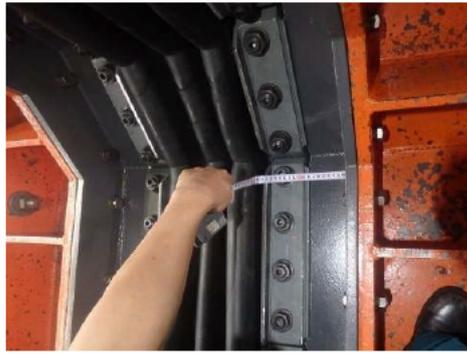
枠-ボルト間距離計測状況
