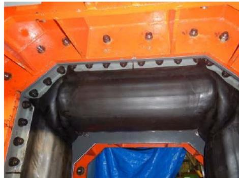
第 5.14.1.2-23 図 試験 No. ⑤ 加圧状況 (0.55 MPa)
