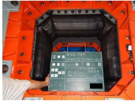
第 5.14.1.2-31 図 試験 No. ⑥ 加圧状況 (0.55MPa)
