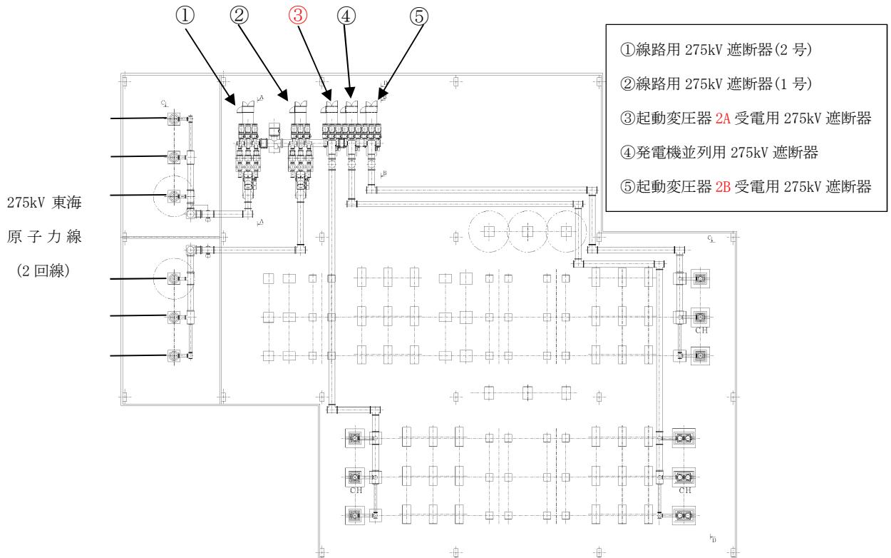
図 8 275kV 超高圧開閉所の平面図
