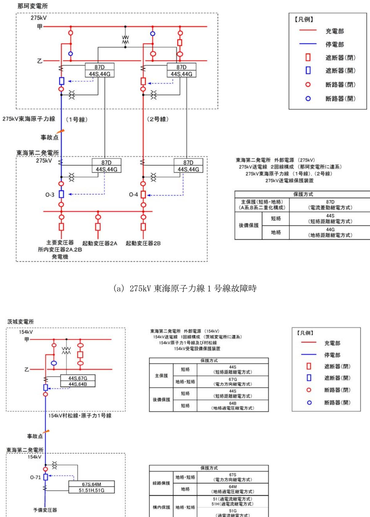
図 6 送電線保護装置
