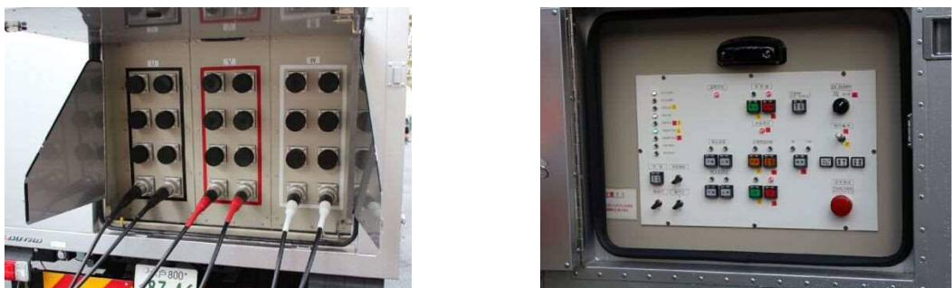
低圧ケーブル接続箇所（可搬型代替低圧電源車） 操作盤
