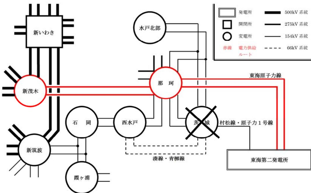
(茨城変電所全停電時の供給系統)
