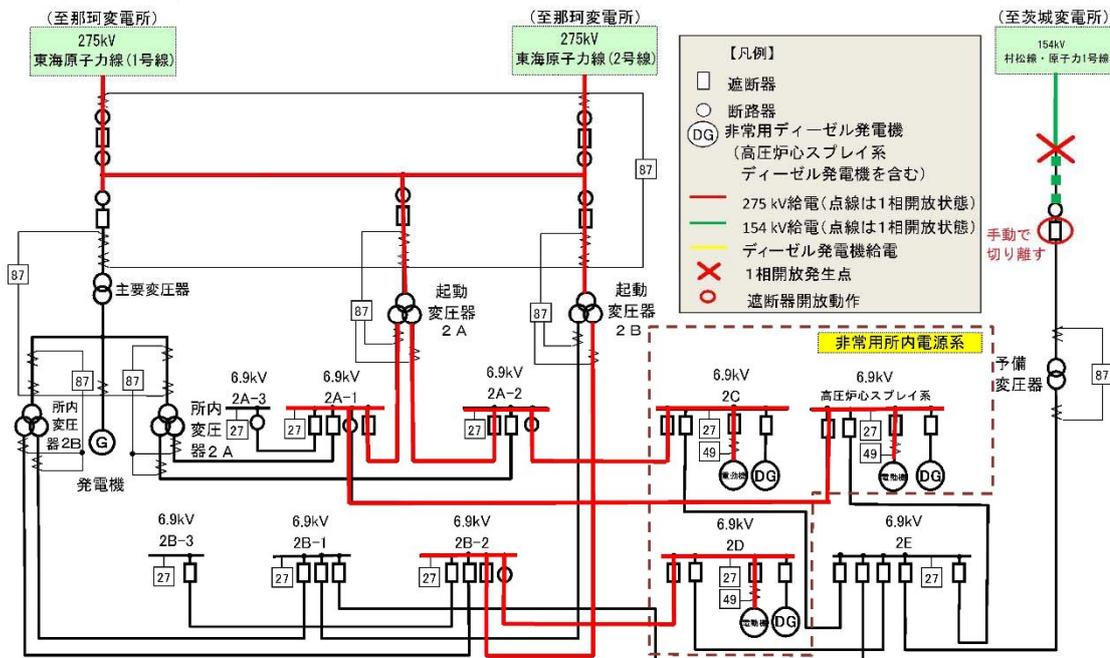
図 1-16 故障箇所を隔離した状態
