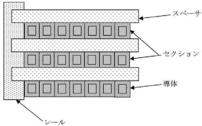
図 1-28 変圧器巻線概要
