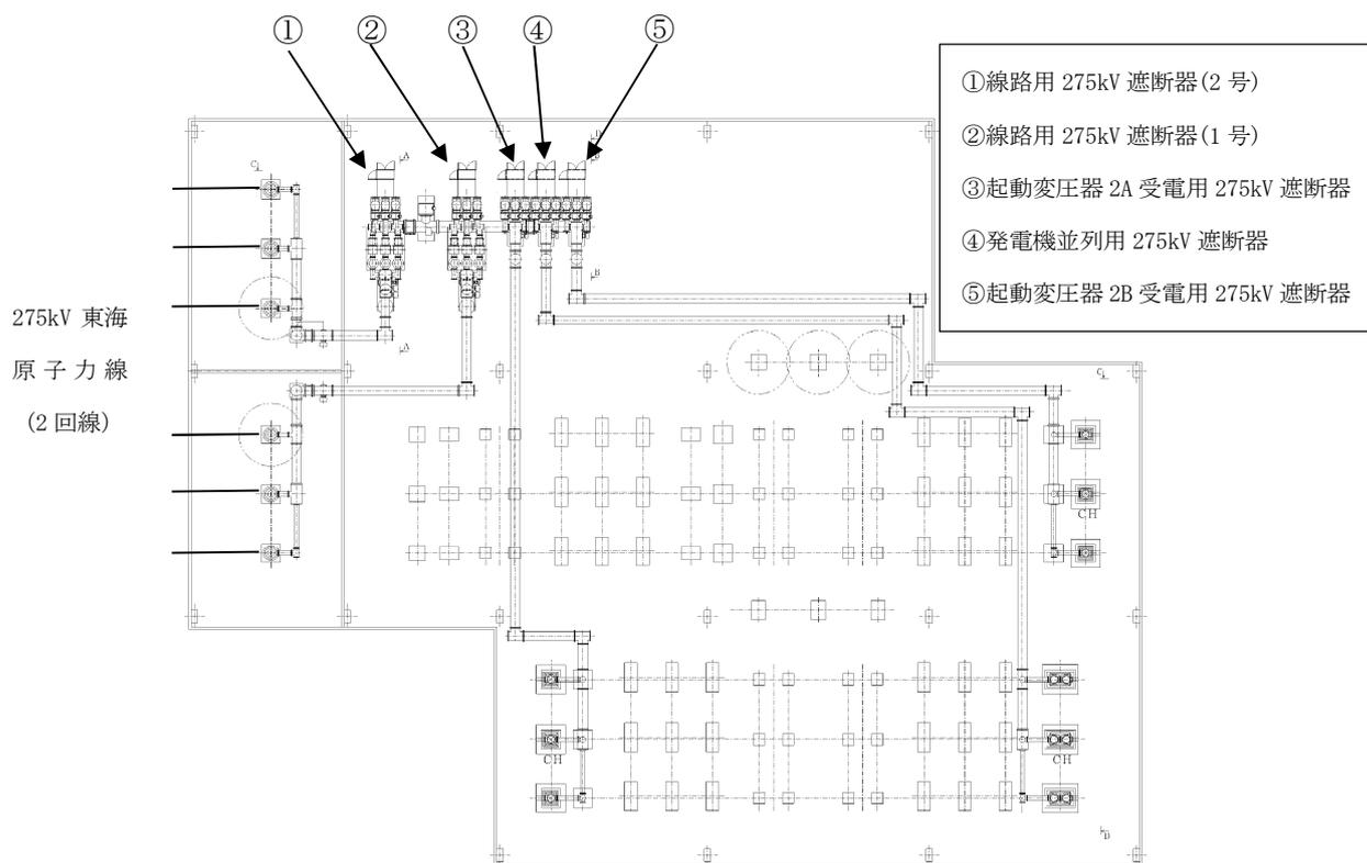
図 3-9 275kV 超高压開閉所の平面図
