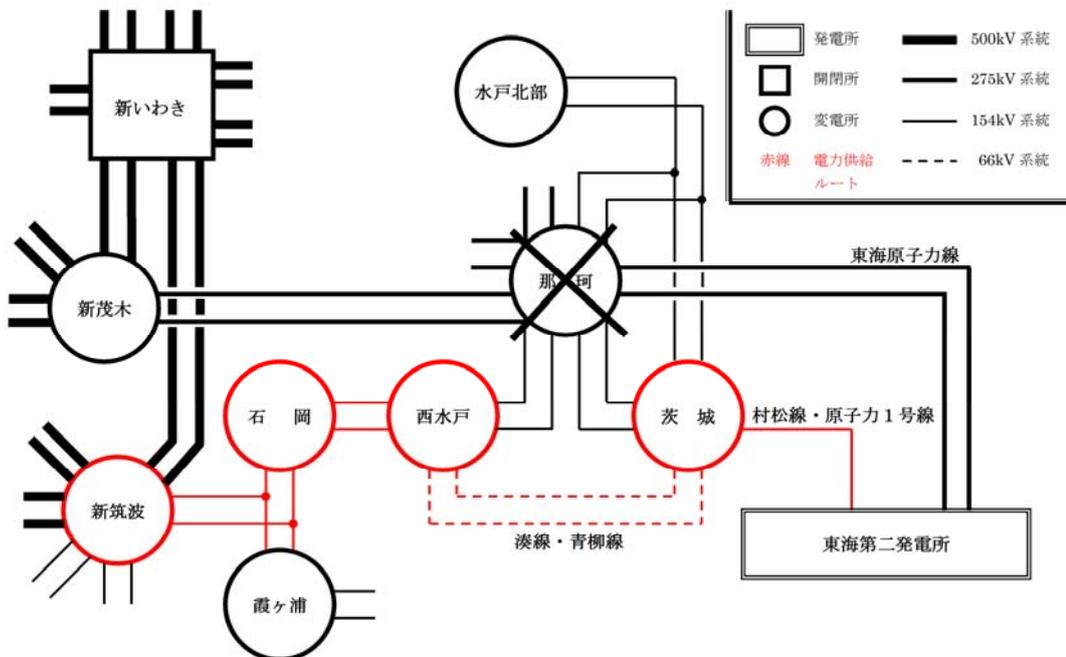
(那珂変電所全停電時の供給系統)
