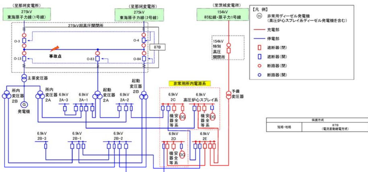
図 1-4 母線保護装置 (275kV 母線事故時)
