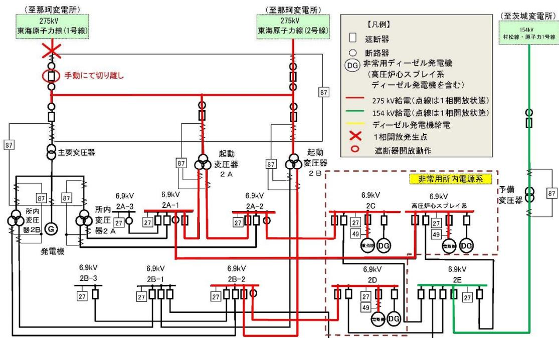
図 1-13 故障箇所を隔離した状態
