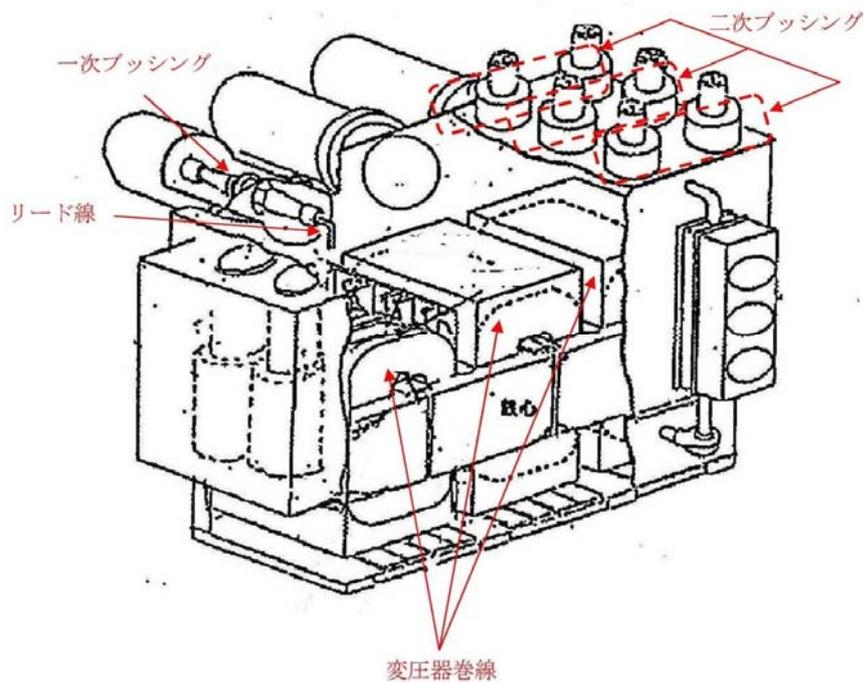
図 1-27 変圧器構造概要 (イメージ)
