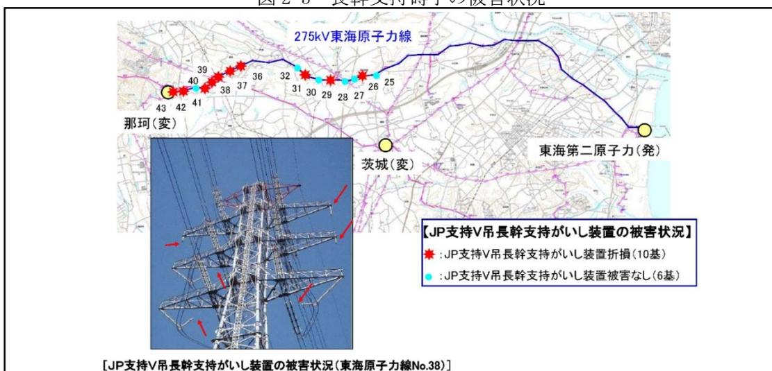
(「東北地方太平洋沖地震におけるジャンパV吊長幹支持がいし装置の折損原因分析結果について
