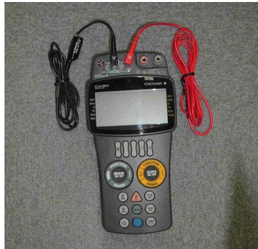
④ 可搬型計測器 (圧力・水位・流量計測用)
