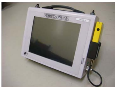
図 2-4 可搬型エリアモニタ
