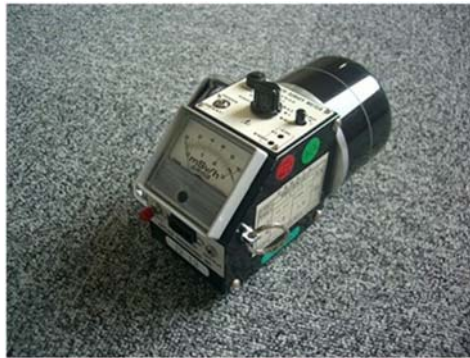
図 2-3 電離箱サーベイメータ
