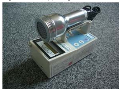
図 2-2 GM汚染サーベイメータ
