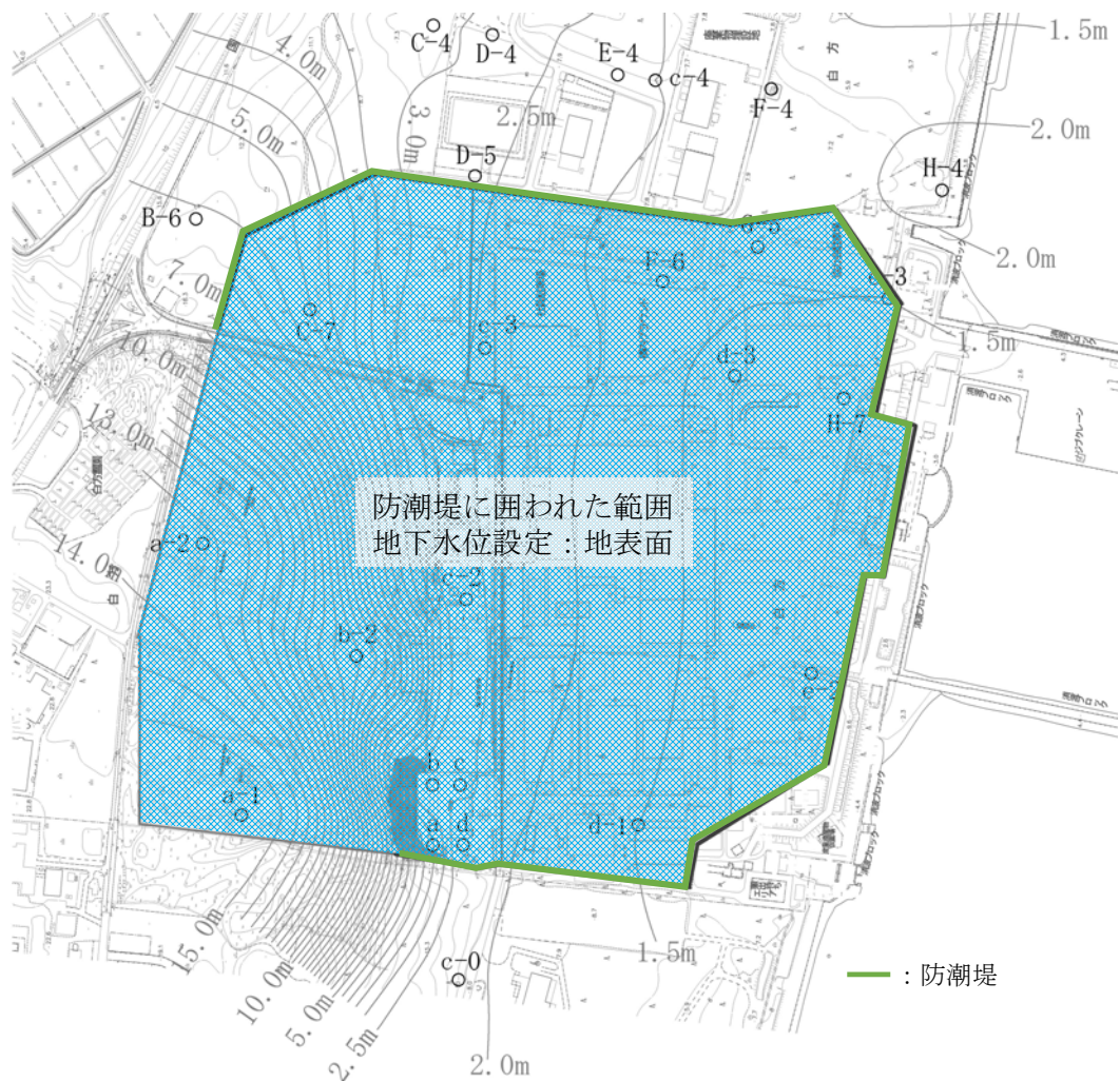
第 10-3 図 地下水位の設定図
