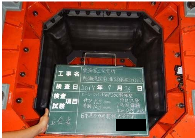
図 5.14.1.2-33 試験 No. ⑥ 漏えい確認 (0.55MPa, 1 時間保持)
