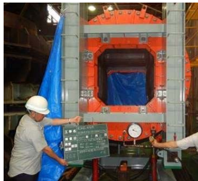
図 5.14.1.2-24 試験 No. ⑤ 加圧完了 (0.55 MPa, 1 時間保持)
