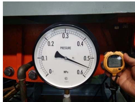
図 5.14.1.2-24 試験 No. ⑤ 加圧完了 (0.55 MPa, 1 時間保持)
