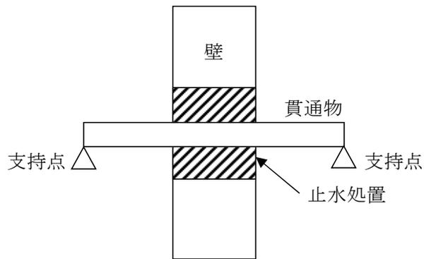
第2-1図 貫通部止水処置の概要図
