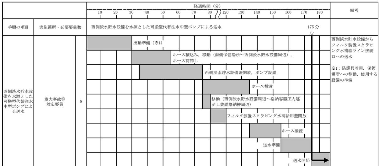
【ホース敷設にホース運搬車を使用する場合, フィルタ装置スクラビング水補給ライン接続口への送水開始まで165分以内と想定する。】
