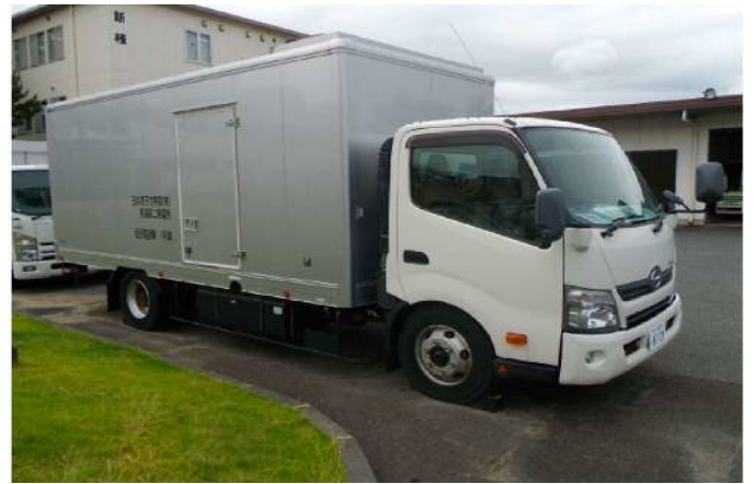
可搬型代替交流電源設備
