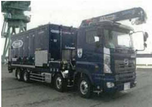
可搬型代替注水大型ポンプ
