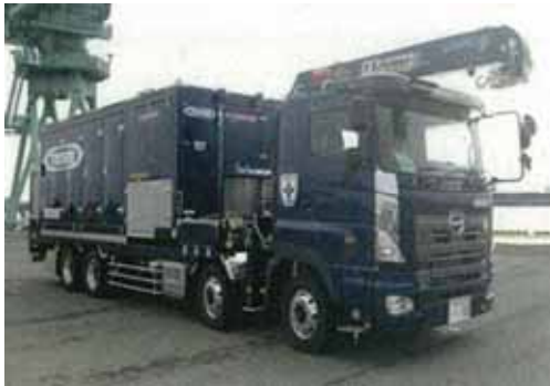
可搬型代替注水大型ポンプ
