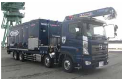
可搬型代替注水大型ポンプ
