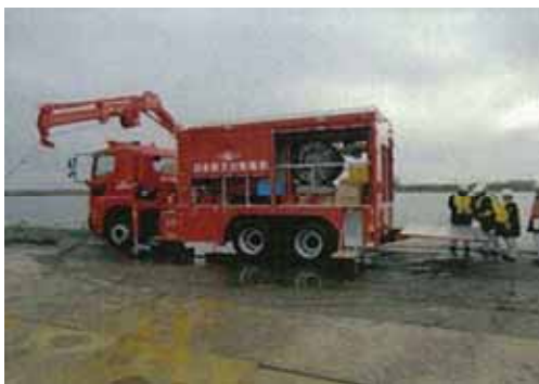
可搬型代替注水中型ポンプ
