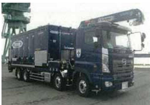
可搬型代替注水大型ポンプ
