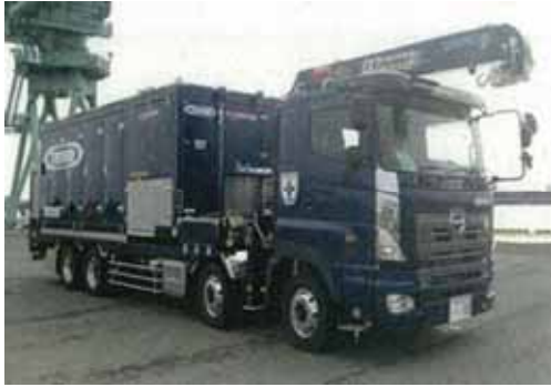
可搬型代替注水大型ポンプ
