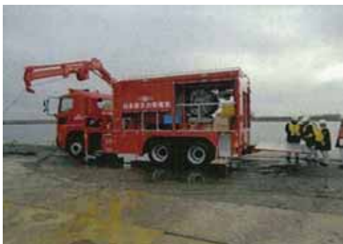
可搬型代替注水中型ポンプ
