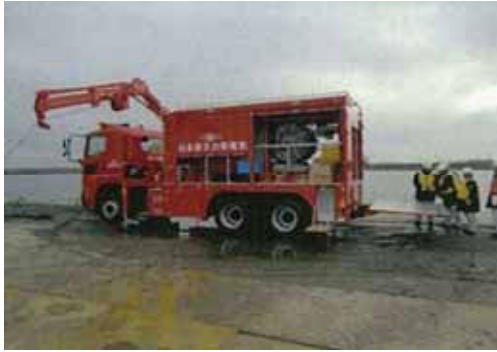
可搬型代替注水中型ポンプ
