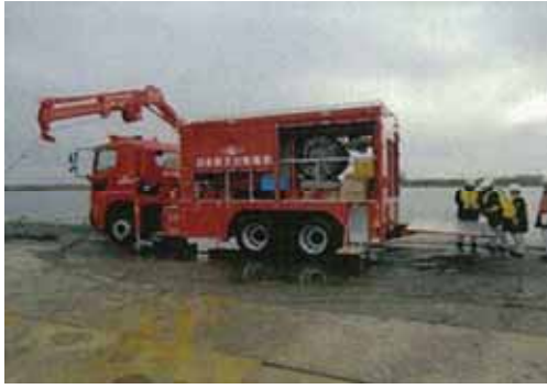
可搬型代替注水中型ポンプ
