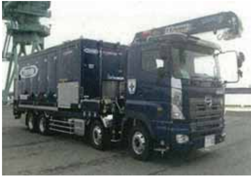
可搬型代替注水大型ポンプ
