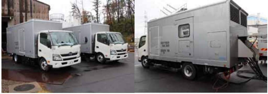
可搬型代替低圧電源車
