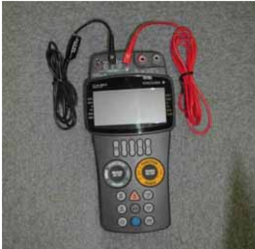
可搬型計測器 (温度、圧力、水位、流量計測用)
