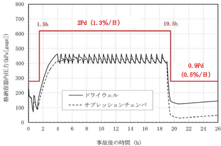
第1図 格納容器圧力と漏えい率の時間変化
