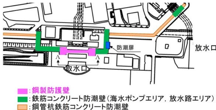
図1 鋼製防護壁の配置図】
