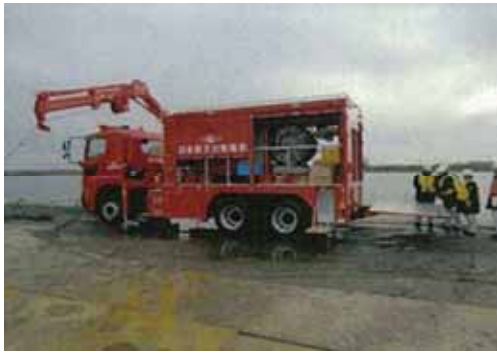
可搬型代替注水中型ポンプ
