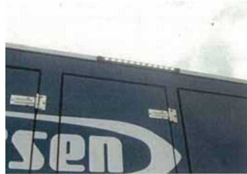
車両の作業用照明
