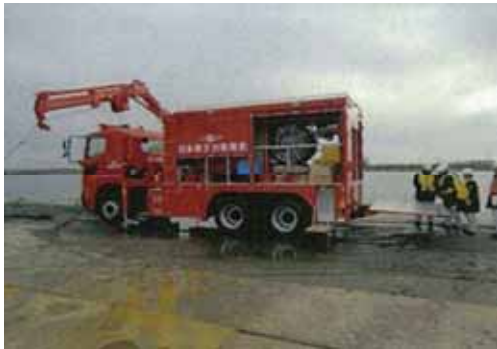
可搬型代替注水大型ポンプ
