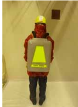
自給式呼吸用保護具着用状態 (後面)
