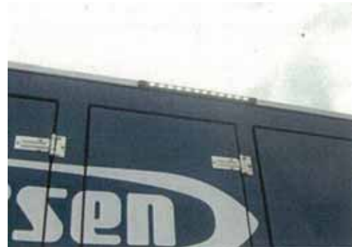
車両の作業用照明
