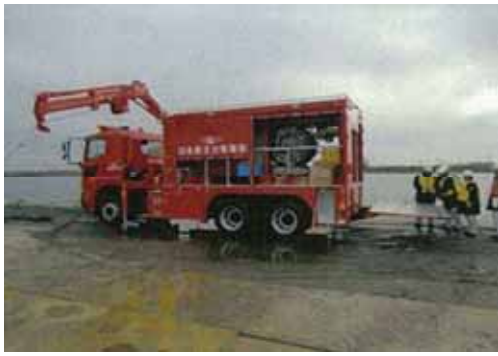
可搬型代替注水中型ポンプ
