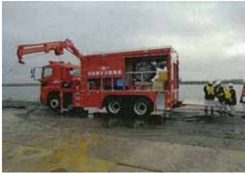
可搬型代替注水大型ポンプ
