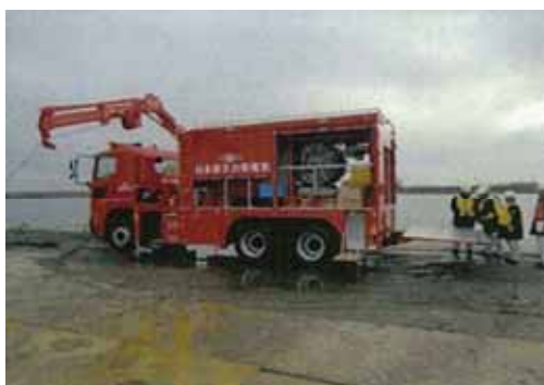
可搬型代替注水中型ポンプ
