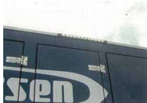
車両の作業用照明
