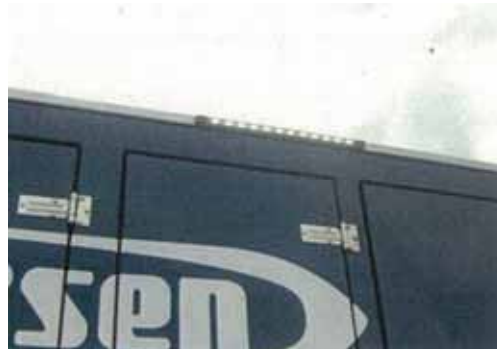
車両の作業用照明
