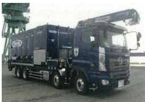
可搬型代替注水大型ポンプ
