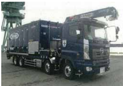
可搬型代替注水大型ポンプ
