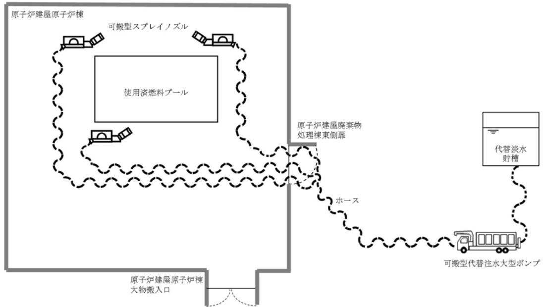
第3.3-4図 可搬型代替注水大型ポンプによる代替燃料プール注水系（可搬型スプレイノズル）を使用した使用済燃料プールスプレイ
