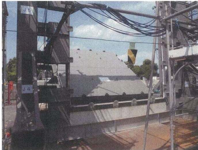
パネル開放試験状況
